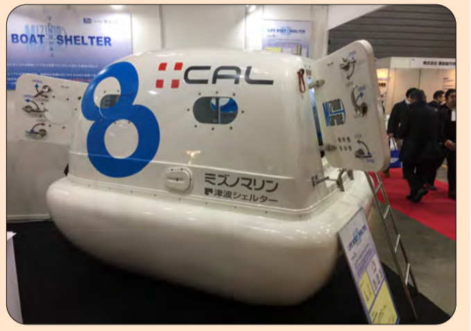
●津波対策の救命ボート、エンジンは無く津波にさらわれた後にブカブカ浮かび救助されるのを待つ仕組みだそうです。
